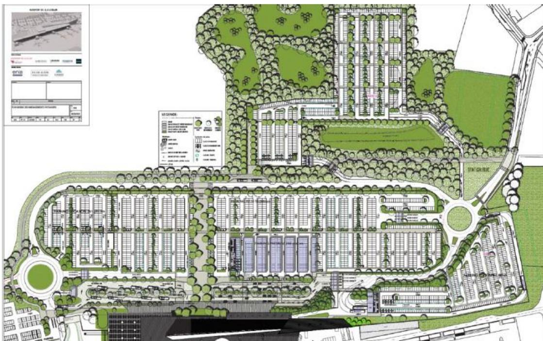
Figure 7. Principe d'aménagement des parkings.
