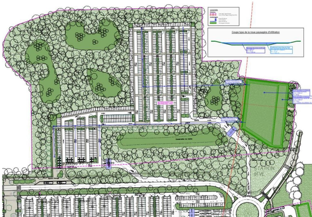
**Figure 32.** Plan de principe de gestion des eaux pluviales du parking P7, noue d'infiltration à l'Est (Etude hydraulique projet, Verdi Environnement).
